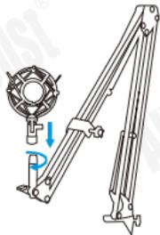
4.5 Ecarter les élastiques et insérer le microphone dans le support
