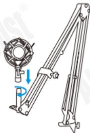
5. Drücken Sie die Federklemme am Schwingungsdämpfer zusammen, um das Mikrofon zu sichern.
